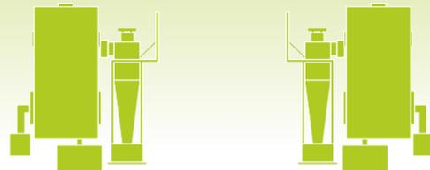
Quegador, motoresreductores, sinfines de aporte y secciones de paso sobredimensionados, ya que la astilla posee una densidad aparente muy baja y un alto grado de humedad, y requiere mayor aporte de combustible.
