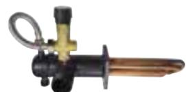
**Sistema de seguridad térmica SOLIMAX:** Kit compuesto por una pieza adaptable a la ida de la caldera con un serpentín de cobre que se introduce en el interior de la caldera y una válvula conectada en el mismo kit que detecta el exceso de temperatura y abre la entrada de agua fría en el caso de sobre temperatura, para ser conducida a un desagüe.
