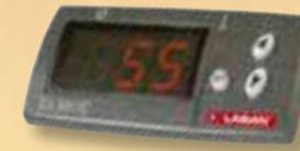
\* La regulación solar SOLMATIC, se encarga de conseguir el calentamiento del acumulador hasta alcanzar la temperatura seleccionada por el usuario, gestionando la conexión y desconexión de la bomba solar en función de los valores de programación elegidos.
