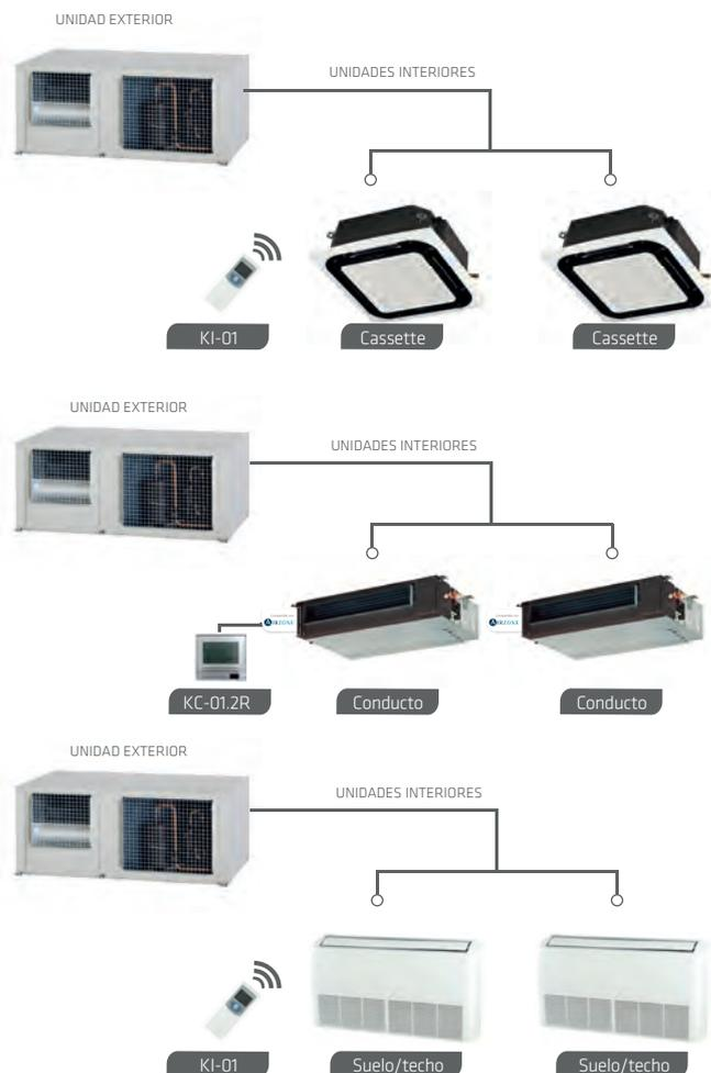
Distancia máxima entre alturas de las unidades interiores de un sistema TWIN: 0,5 metros
