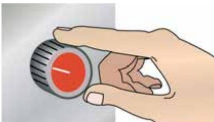
La regulación del caudal de aire y de la presión disponible se realiza cómodamente mediante el uso de un potenciómetro localizado en el cuadro eléctrico.
