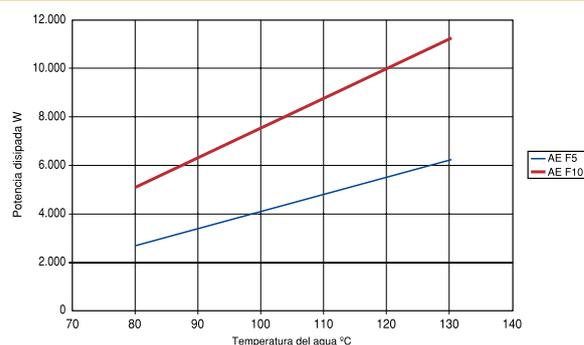
Gráfico de selección del modelo apropiado de aerotermosto en función de la temperatura de entrada para una temperatura exterior de 35°C
