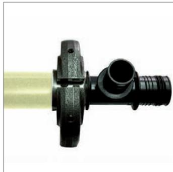
5. Insertar la cuna adecuada al diámetro exterior del tubo que se está conectando. Colocar la boca de la prensa centrada en el casquillo, pegando a la balona (No presar nunca fuera del casquillo).
