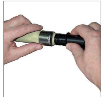
3. Colocar el casquillo sobre el tubo, hasta el final y después introducir la boquilla del accesorio. De esta forma puede observarse si pellizca la junta en la ejecución.
