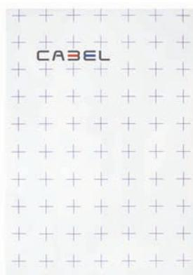
Panel aislante CABEL liso, fabricado en poliestireno expandido (EPS), autoextinguible (Euroclase E) de 25mm de espesor, densidad de 20 kg/m<sup>3</sup>, cubierto por una lámina superficial de polietileno tereftalato (PET), de 0,25mm de espesor, provisto de solapas para unión entre paneles y cuadrícula de guía serigrafiada.
