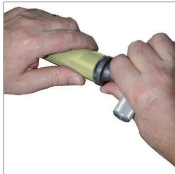
2. Con el calibrador, rebarbar el tubo para que no dañe las juntas al introducir el accesorio.
