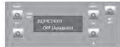
Cuadro de control con un display de gran tamaño, indica el estado de la estufa, su modo de funcionamiento, la temperatura ambiente, la fecha, la hora, la potencia seleccionada y otros datos útiles de funcionamiento, además dispone de programador horario.
