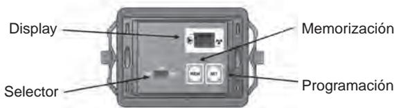
Si la temperatura del agua del insertable es superior a la programada se activan los circuladores del grupo hidráulico y se desactiva la caldera, suministrando así el agua de la calefacción únicamente mediante el insertable. Por el contrario si la temperatura es inferior a la programada será la caldera quien aporte el calor para la instalación.
