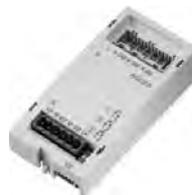
**AGU 2.550.** Interface control de una zona de baja temperatura y hasta 3 de alta temperatura y sistemas solares. Gestión remota de caldera con señal 0-10 V y control de recirculación sanitaria. Ubicación interna en la placa electrónica de la caldera.
