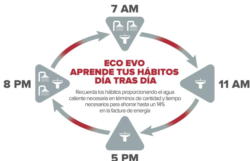
Para prever posibles demandas de agua adicionales, ECO EVO siempre mantendrá una temperatura mínima de seguridad de 45°C.
